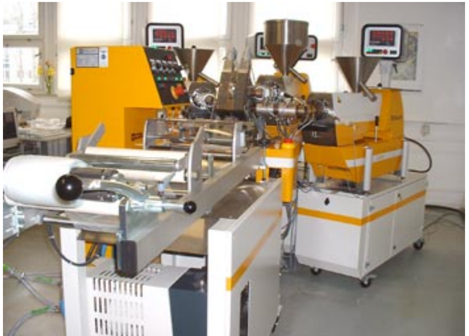
Abbildung 3 Thermochrome Polymerfolien mit reversiblen oder irreversiblen Schaltungen können mittels Extrudertechnologie hergestellt werden.
