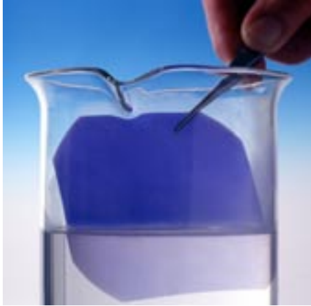
Abbildung 1 Thermochrome Polymerfolie mit einer reversiblen Schaltung zwischen Blau und Farblos.
