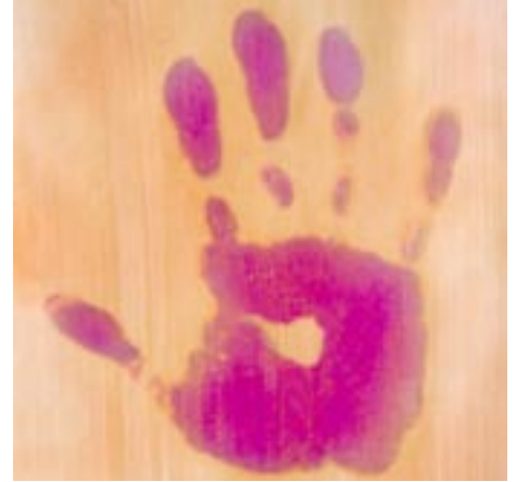
Abbildung 2 Thermochrome Folie mit einer irreversiblen Schaltung von Farblos nach Magenta.
