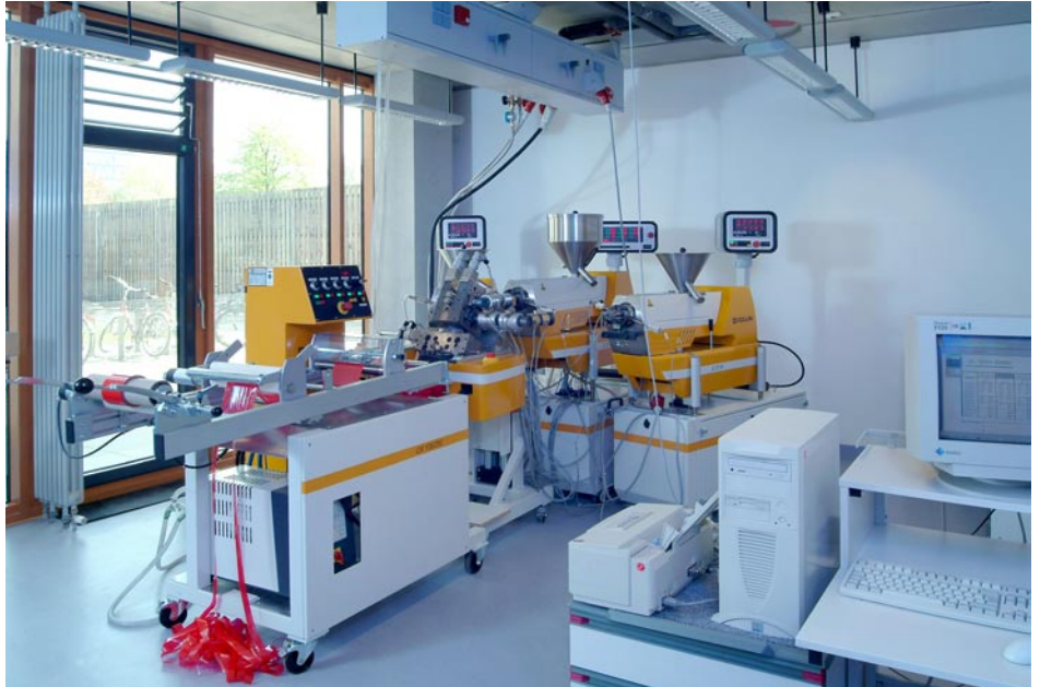
Abbildung 1 Extruderanlage zur Herstellung von Ein- und Mehrschichtpolymerfolien.
